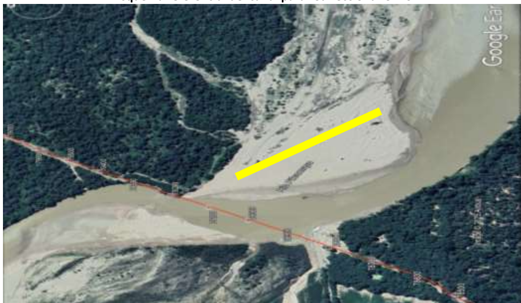
Imagen 3 Esquema referencial del canal para redireccionar el río
