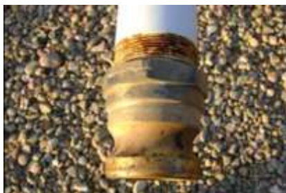
Figura 3. Acople macho de 2" de tanque en ECV
